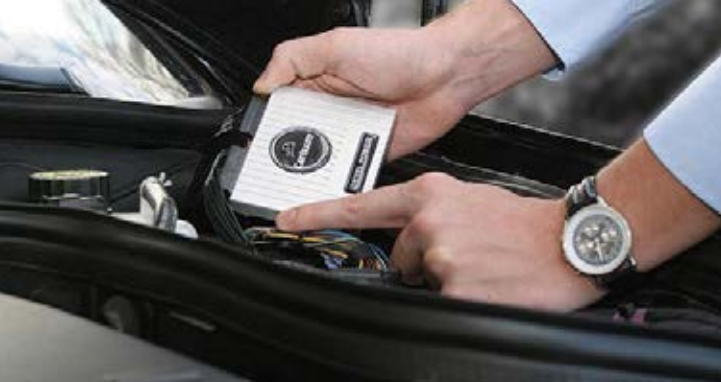
Einbau eines Zusatzsteuergerätes zur Leistungssteigerung
